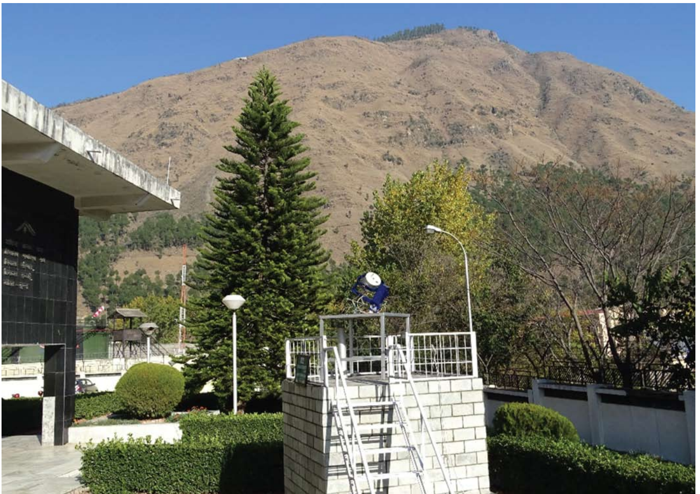
चित्र 19: मोहाल में एयरोसोल माप के लिए स्थापित मल्टी-वेवलेंथ रेडियोमीटर (MWR) को दिखाता है।
